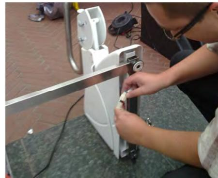
2. Verbindungselement am Gerät positionieren, wunschgemäß eine Alternative auswählen. Dann das Verbindungskabel am linken und rechten Fuß anschließen
