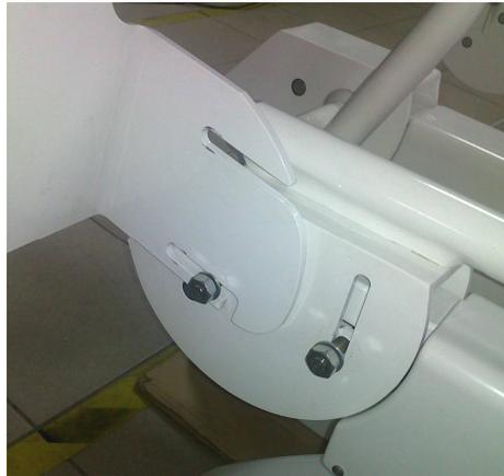
2 Sitzplatte an der linken und rechten Fuß einsetzen und mit der Mutter **leicht** festziehen.
