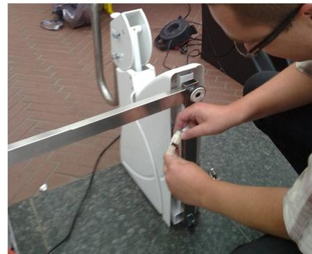
2. Verbindungselement an das Gerät positionieren, wunschgemäß eine der alternativen auswählen – dann Verbindungskabel an der linken und rechten Fuß anschließen
