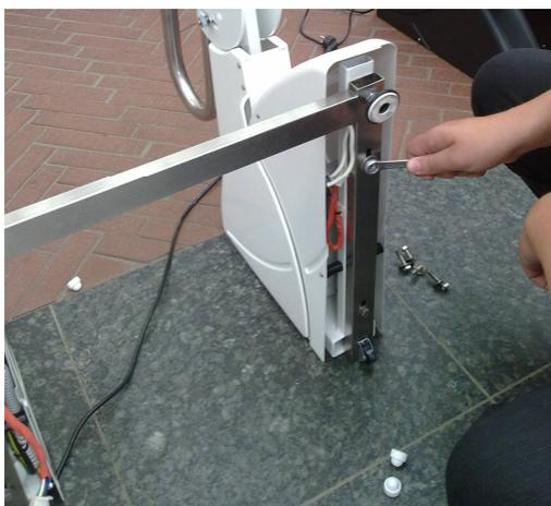
3. Nach Anschluss der Verbindungskabel mittels mitgelieferten Schrauben das Verbindungselement an die Füße festschrauben.
