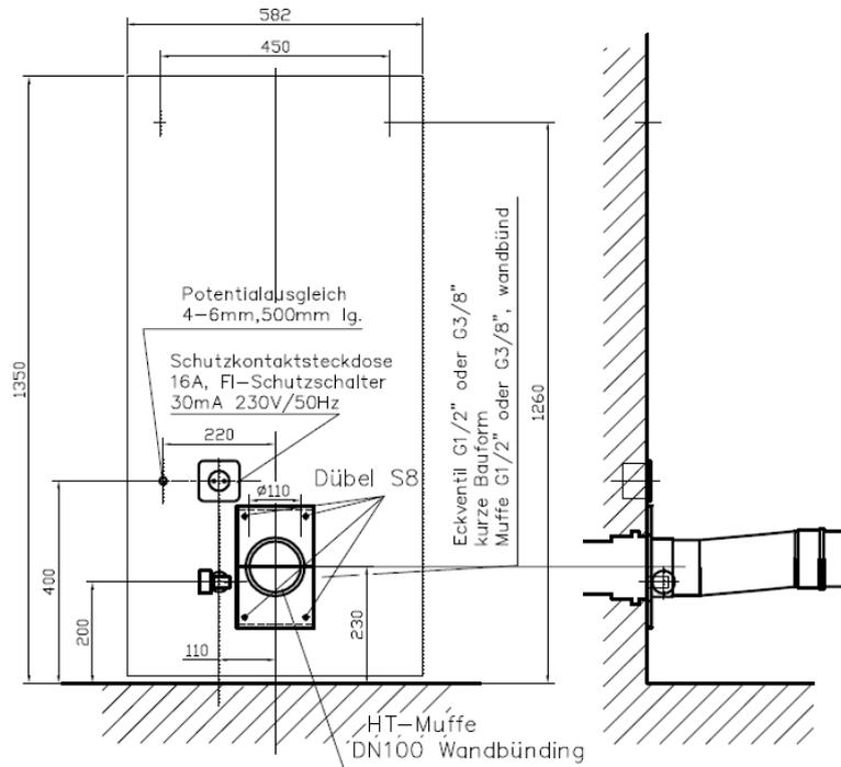
2. Verbinden Sie die mitgelieferte Wasseranschlusseinheit mit dem Eckventil. Die Lage der Anschlüsse muss bei der Betrachtung von oben wie im Bild sein! Testen Sie es auf Leckage mit einem Testrohr !!!
