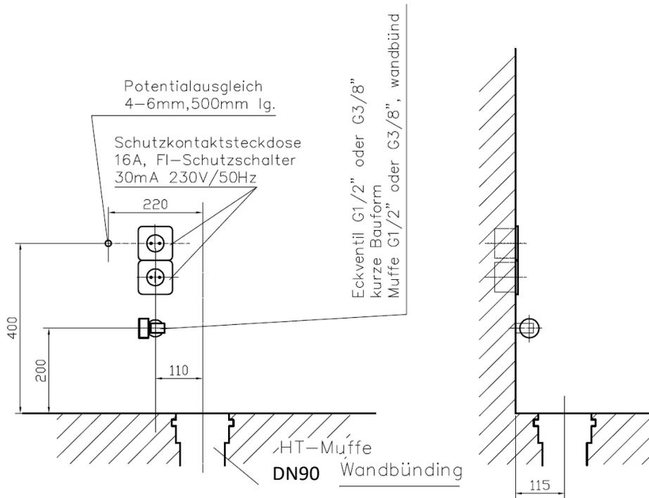
2. Schließen Sie die mitgelieferte Wasseranschlusseinheit an das Eckventil an. Die Position der Anschlüsse müssen von oben gesehen wie folgt sein! Mit einem **Test Rohr auf Dichtheit prüfen!!!**
