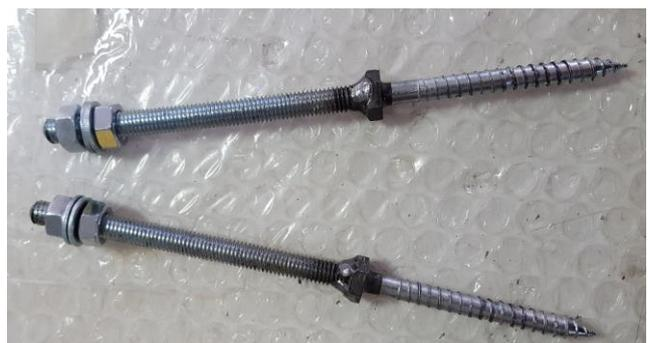
Die Mutter festschrauben und eine Unterlegscheibe auf jedes Schraubengewinde legen.
