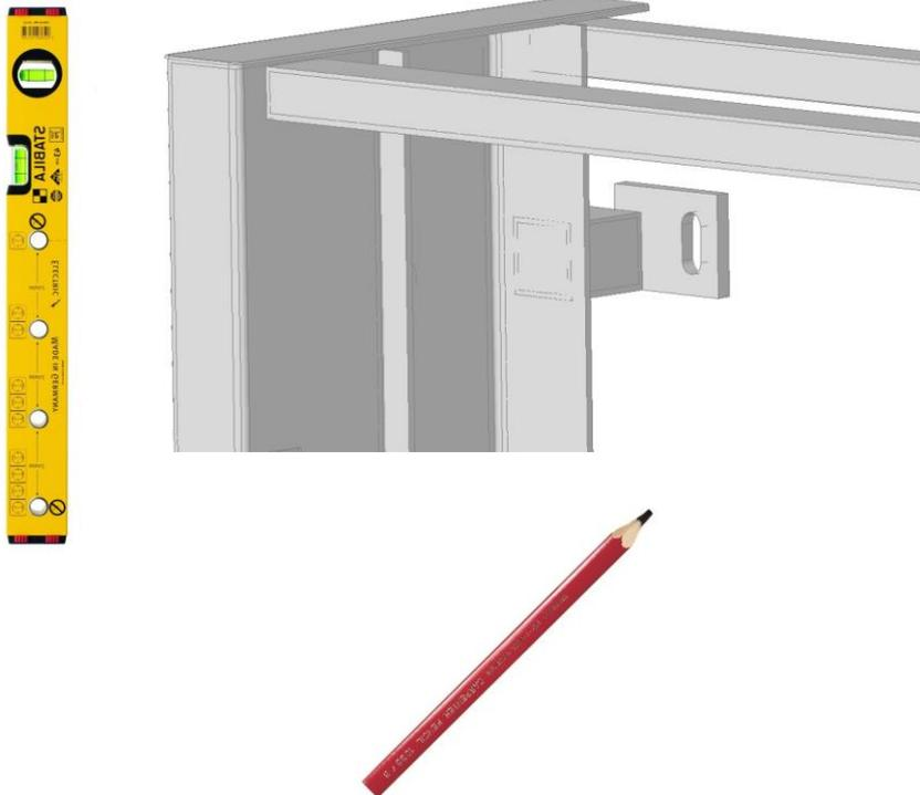
Wenn Sie die genaue Position der Maschine ermittelt haben, markieren Sie die Position der beiden Wandmontageschrauben.
