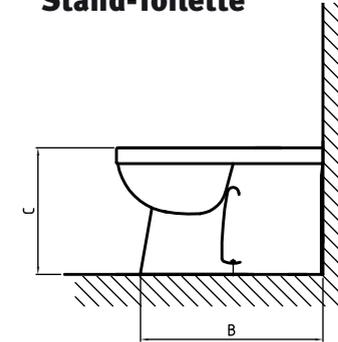
Gemäß untenstehender Skizze bedarf es für die korrekte Anbringung der Aufstehhilfe R2D2 lediglich eines Abstandes von 350 mm jeweils von der Mittelachse der Toilette.
